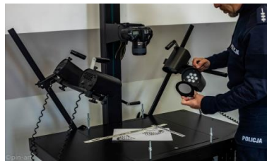
a) Oświetlenie stołu z odczepioną lampą bez założonego dyfuzora
