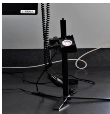
Fot. 4. Lampa z jedną diodą LED do podświetlania od spodu wraz z regulowanym stojakiem.
