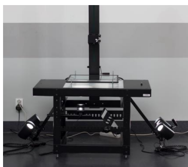
f) Lampy LED opuszczone, oświetlenie dolne przechodzące.
