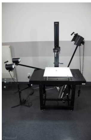
c) Lampy LED oddalone od stołu i ustawione pod różnym kątem.
