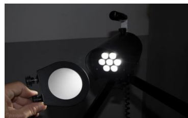
c) Włączona lampa ze światłem przechodzącym przez dyfuzor
