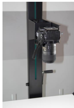
f) boczne mocowanie uchwytu na aparat
