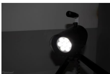
d) Pojedyncza lampa z siedmioma diodami LED z zamontowanym dyfuzorem do rozpraszania światła.
