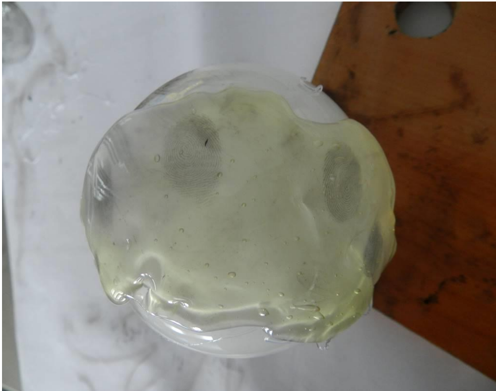
Fot. 35. Ślady linii papilarnych na kloszu żarówki po nałożeniu gorącego kleju. (źródło własne)
