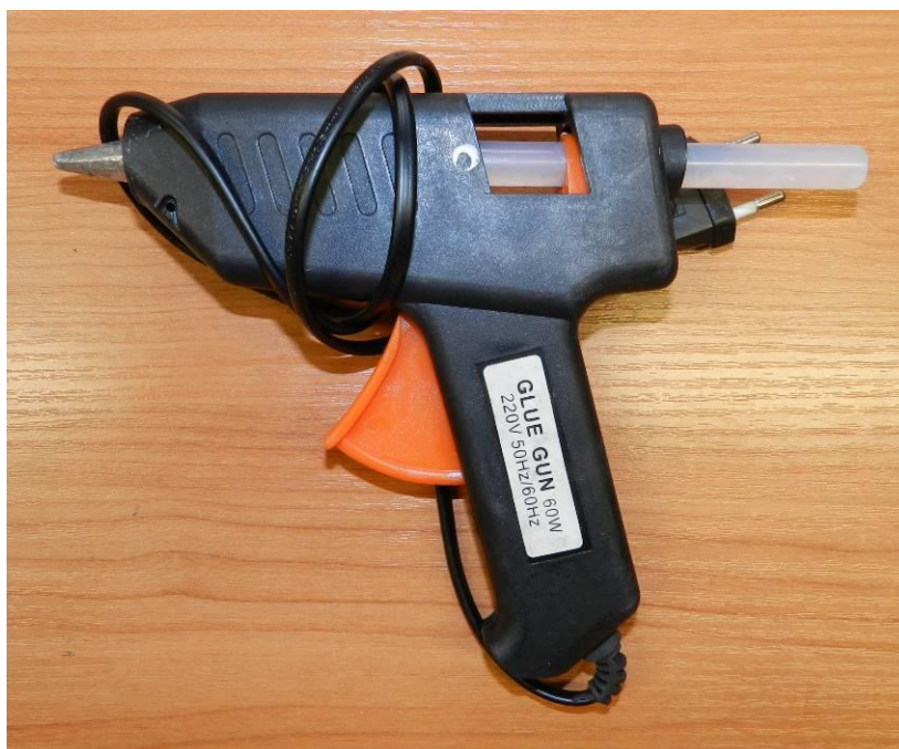
Fot. 3. Pistolet klejowy o mocy 60W z włożonym wkładem klejowym (źródło własne).
