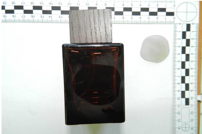
Fot. 25. Boczna ścianka pojemnika szklanego po wodzie toaletowej - miejsce ujawnienia odwzorowania linii papilarnych (źródło własne).
