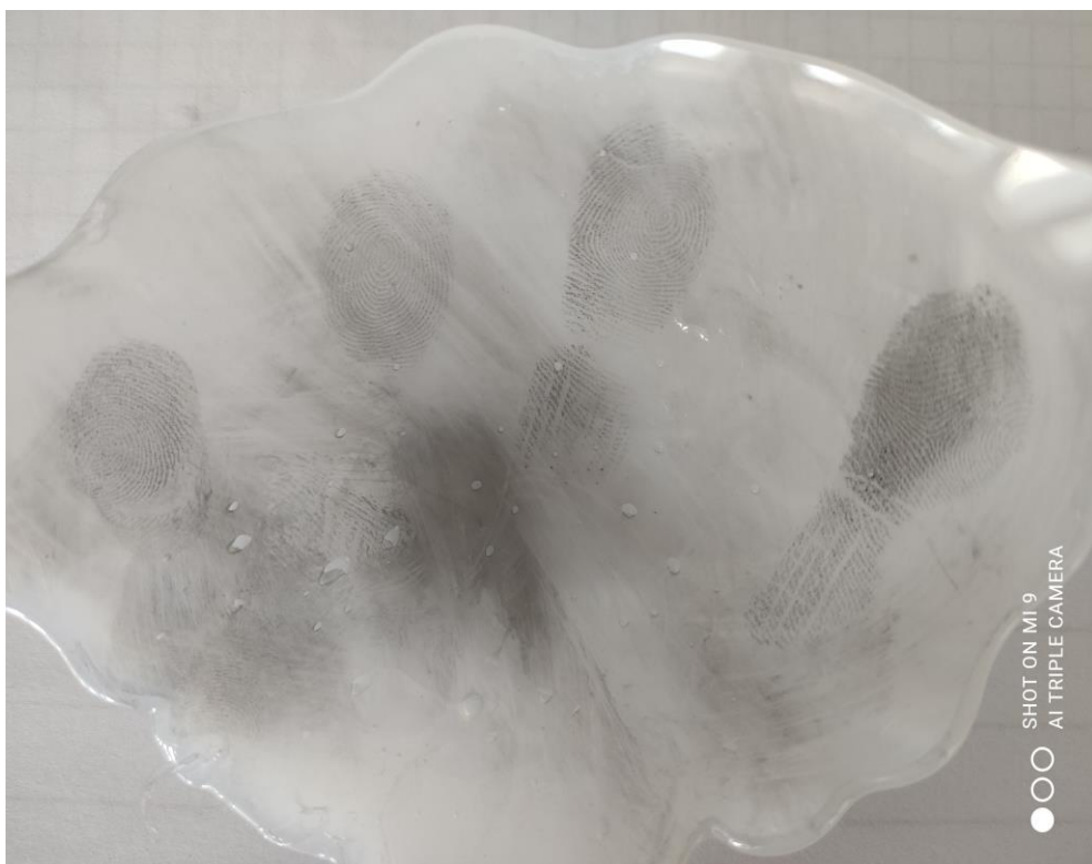
Fot. 36. Wykonana replika klejowa z odwzorowaniem linii papilarnych (źródło własne).
