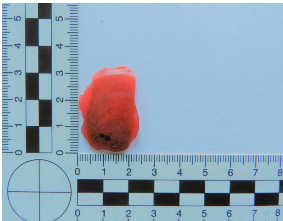
Fot. 45. Ślad linii papilarnych z denka puszki zabezpieczony w postaci repliki klejowej koloru czerwonego (źródło własne).
