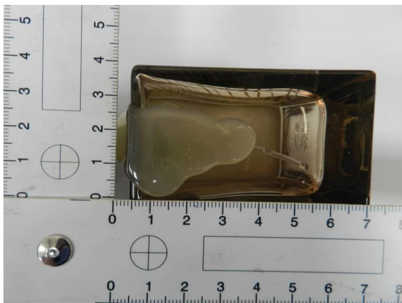
Fot. 30. Klej barwy żółtawej wylany na sąsiadujące powierzchnie w miejscu występowania śladu - flakon jaśniejszy (źródło własne).
