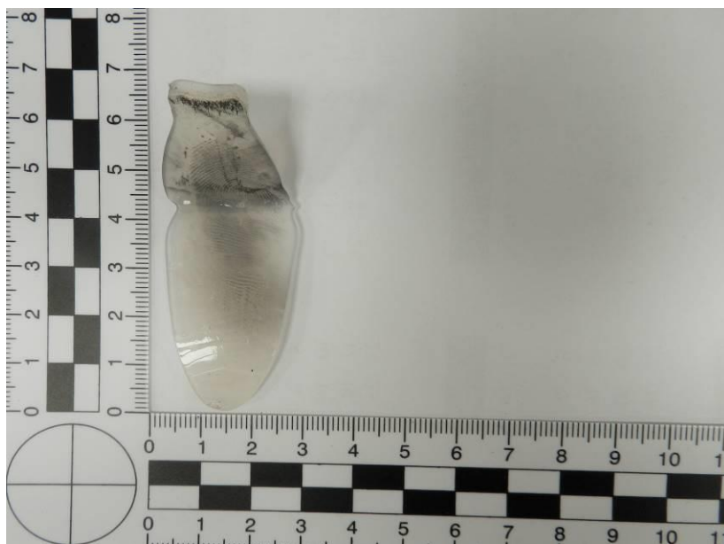
Fot. 29. Replika klejowa ze śladem po oderwaniu od powierzchni (źródło własne).
