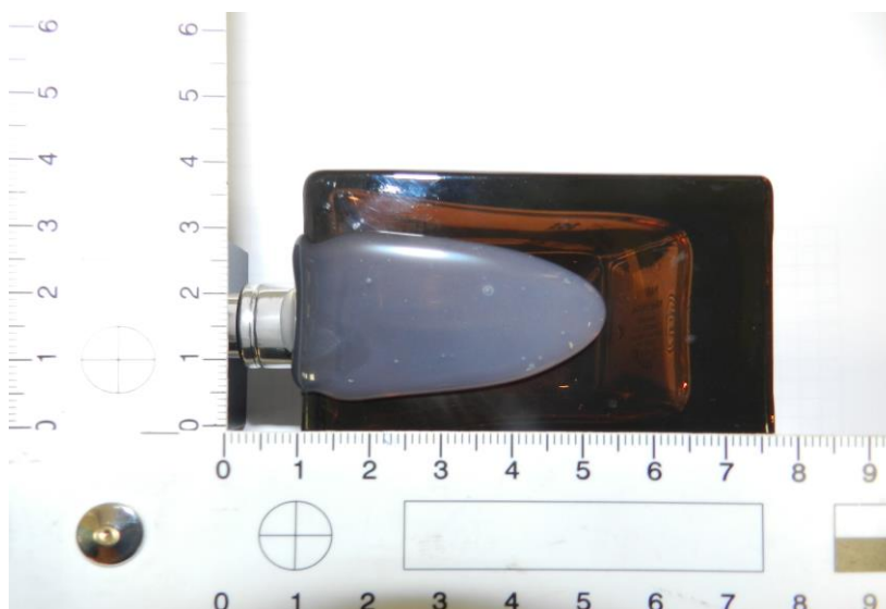
Fot. 28. Przezroczysty klej wylany na sąsiadujące powierzchnie w miejscu występowania śladu (źródło własne).
