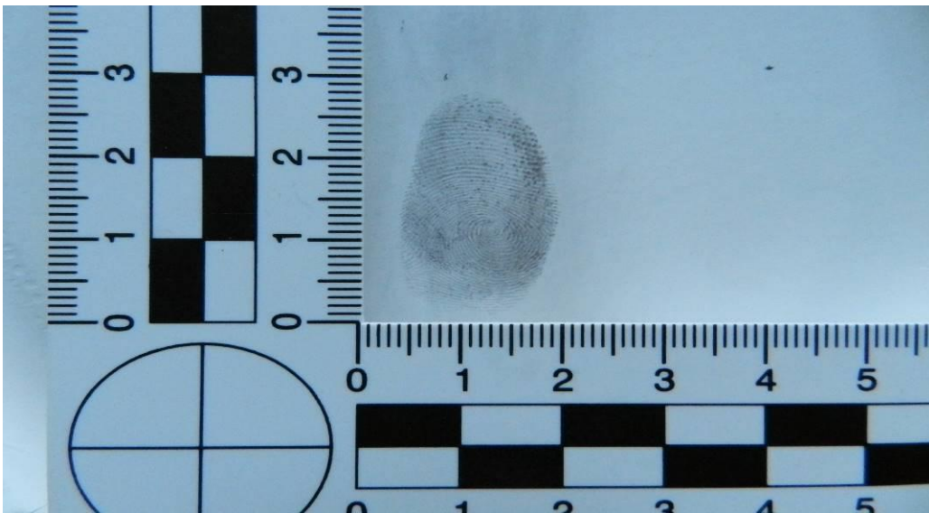
Fot. 55. Ślad linii papilarnych ujawniony proszkiem magnetycznym na papierowym talerzu (źródło własne)
