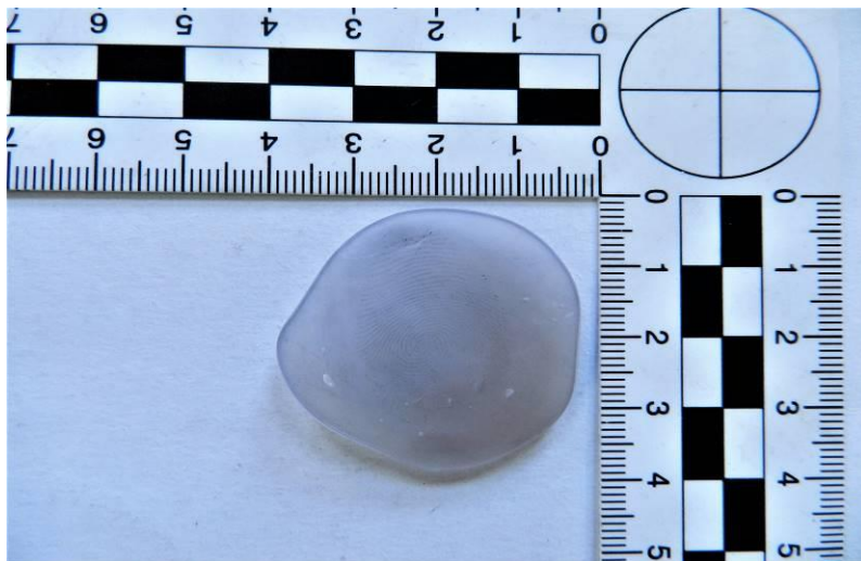
Fot. 26. Wykonana replika klejowa z odwzorowaniem linii papilarnych (źródło własne).
