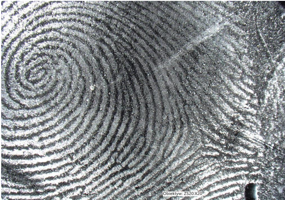
Fot. 59. Replika klejowa koloru czarnego ze śladami linii papilarnych. (źródło KWP w Bydgoszczy)
