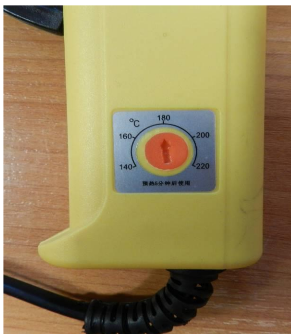
Fot. 8 Skala temperatury na uchwycie pistoletu (źródło własne).
