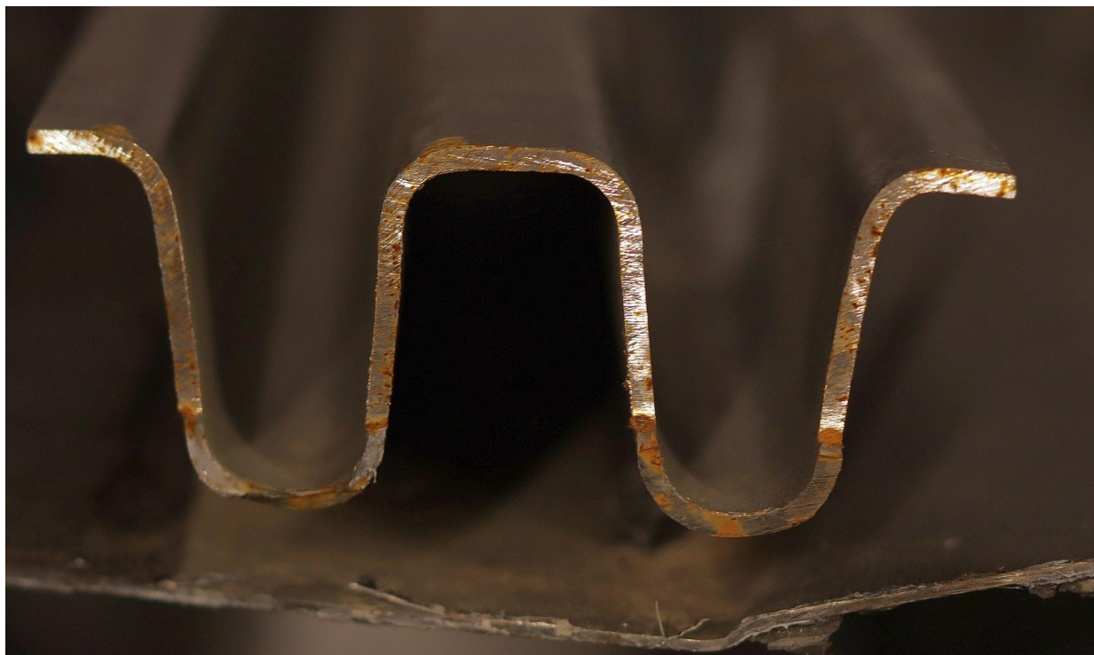
Zdj. 7. Wzmocnienie boczne drzwi profil otwarty o grubości 2 mm – przekrój. Archiwum autora.
