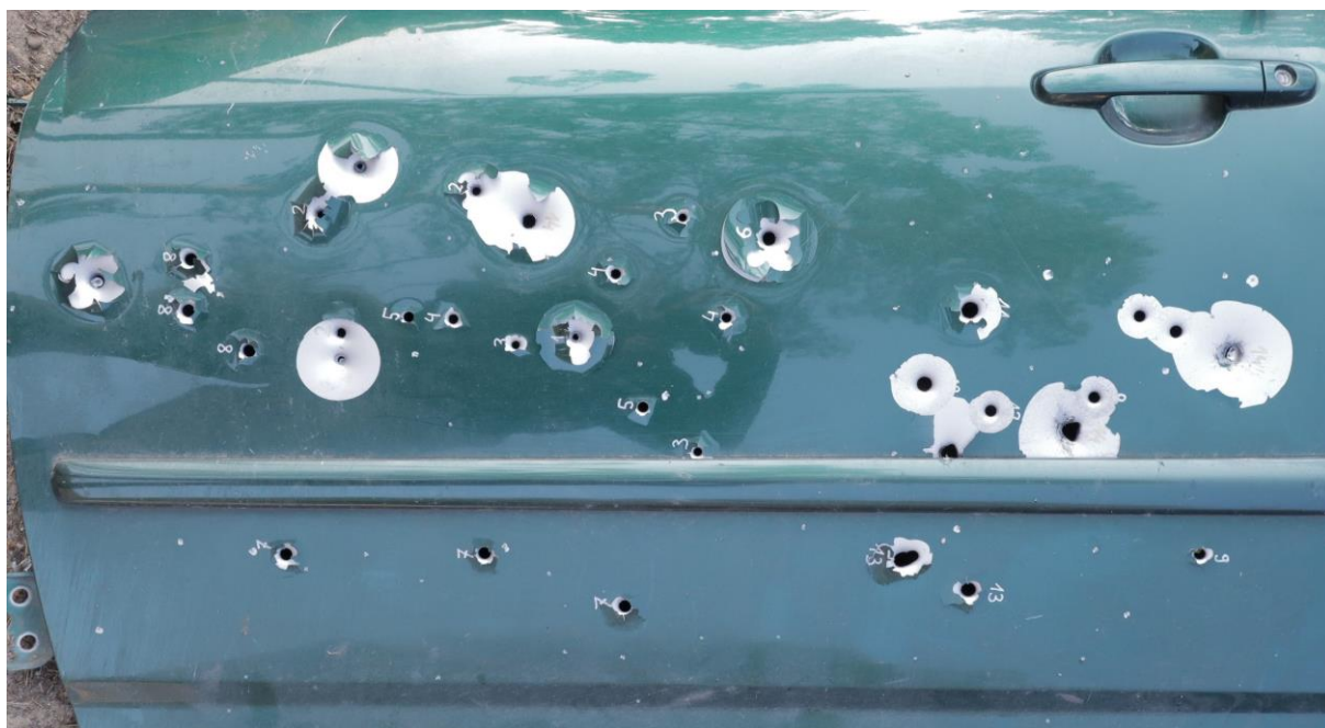
Zdj. 5. Drzwi po zakończonych próbach – strona zewnętrzna. Archiwum autora.
