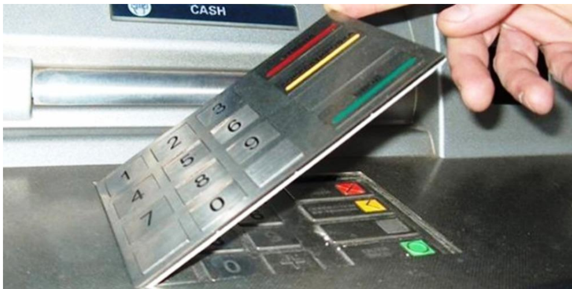
Ryc. 12. Nakładka na klawiaturę bankomatową.
