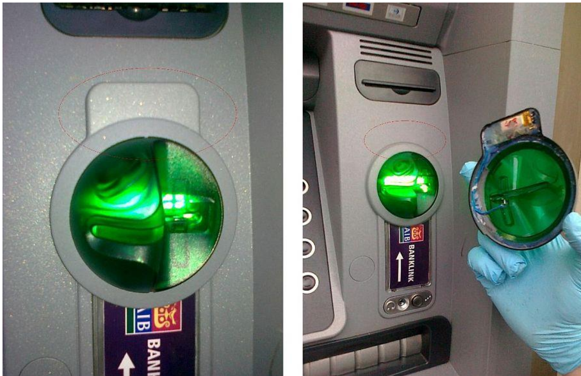
Ryc. 13. Skimmer w postaci nakładki na slot bankomatu.
