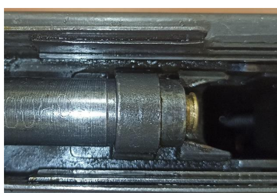
Zdj. 9. Nieprawidłowe (lewa ilustracja) i prawidłowe osadzenie lufy w obsadzie lufy (prawa ilustracja). Widoczna różnica w głębokości wprowadzenia naboju do komory nabojoyej.
