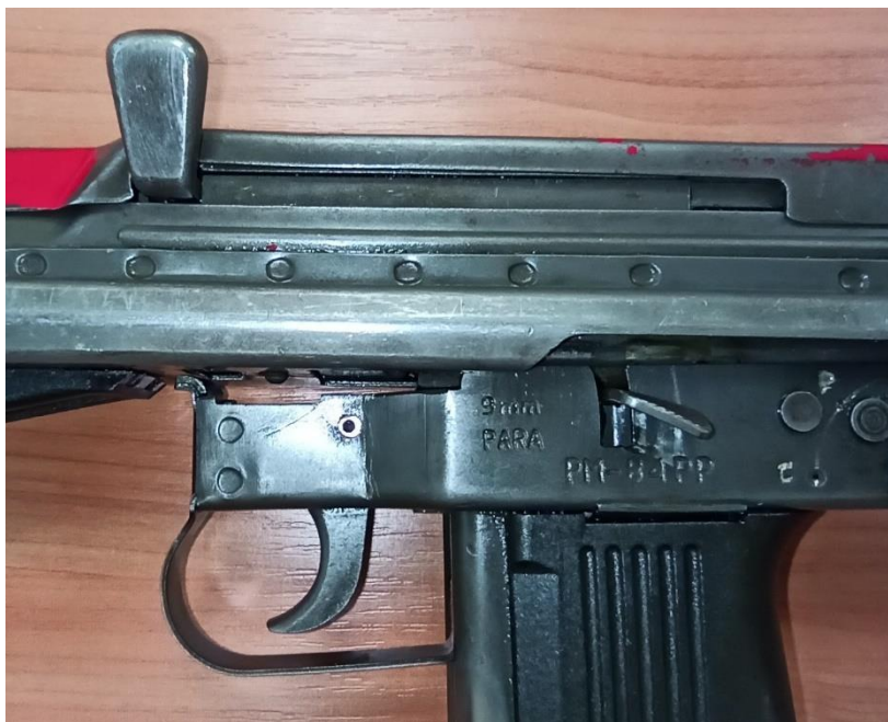
Zdj. 2. Nieprawidłowy sposób połączenia zespołu komory zamkowej i kolby z zespołem chwytu.
