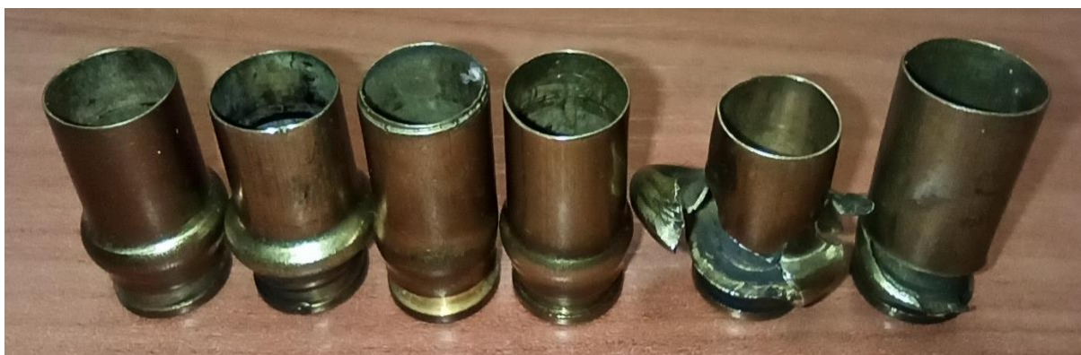
Zdj. 10. Rozdęte i perforowane łuski.
