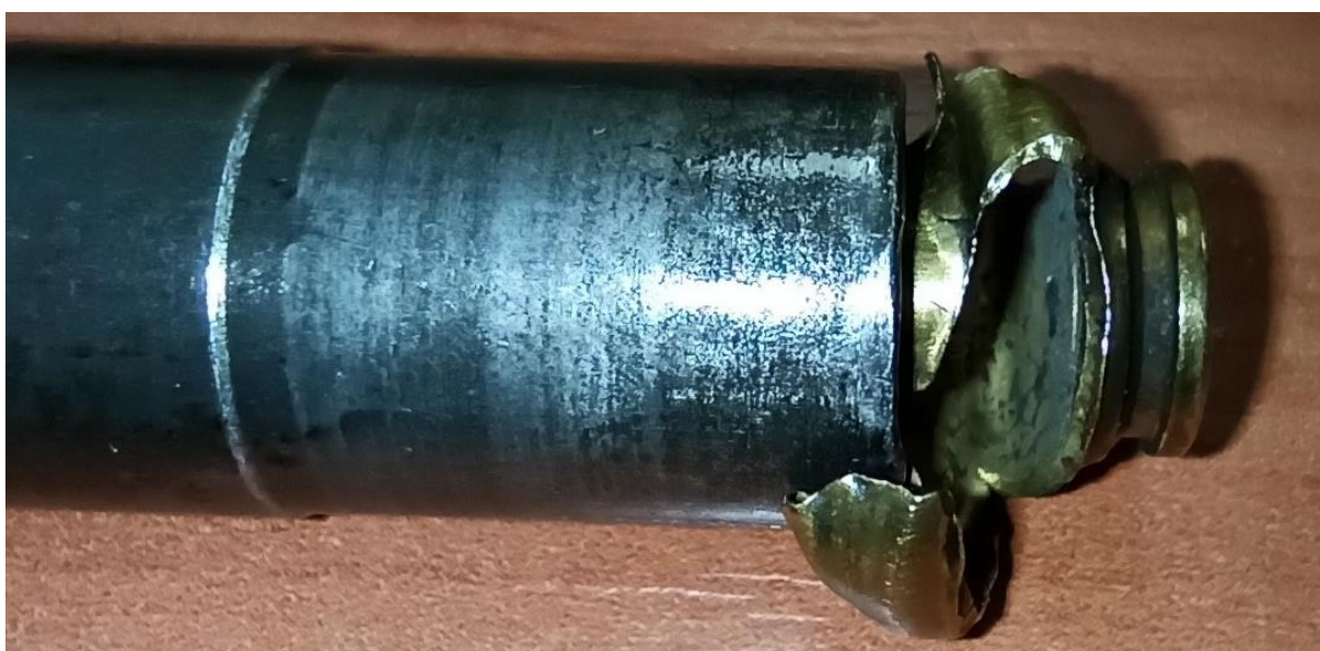
Zdj. 13. Lufa i perforowana łuska.
