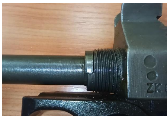
Zdj. 8. Nieprawidłowe (lewa ilustracja) i prawidłowe osadzenie lufy w obsadzie lufy (prawa ilustracja). Przyczyna pozycjonowanie lufy bokiem do boku kołnierza zamiast „czołem do czoła”.
