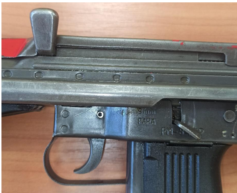
Zdj. 3. Prawidłowy sposób połączenia zespołu komory zamkowej i kolby z zespołem chwytu.
