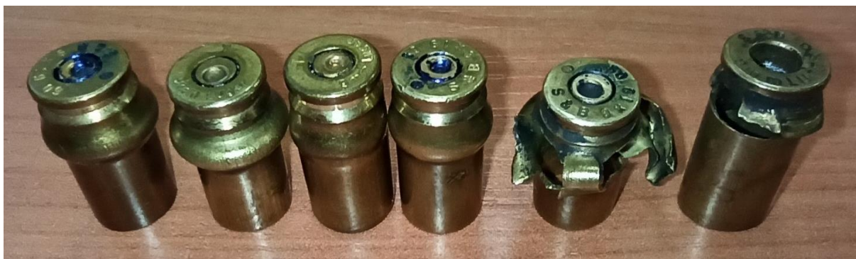
Zdj. 11. Rozdęte i perforowane łuski.
