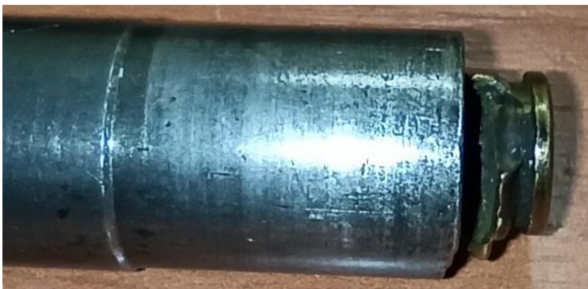
Zdj. 12. Lufa i perforowana łuska.
