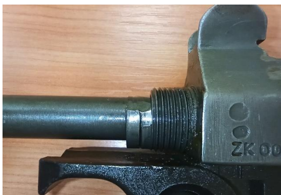
Zdj. 8. Nieprawidłowe (lewa ilustracja) i prawidłowe osadzenie lufy w obsadzie lufy (prawa ilustracja). Przyczyna pozycjonowanie lufy bokiem do boku kołnierza zamiast „czołem do czoła”.
