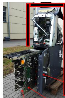
Zdj. 17. Uszkodzenia bankomatu w wyniku wybuchu przestrzennego. Źródło: Materiał własny.
