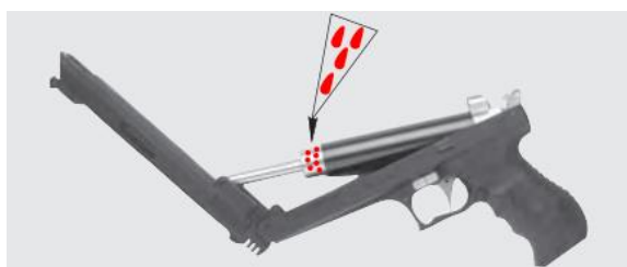
Rys. 18. Konserwacja pistoletu pneumatycznego HW 40 PCA
