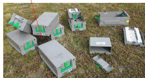
Zdj. 18. Uszkodzenia bankomatu w wyniku wybuchu przestrzennego. Źródło: Materiał własny.
