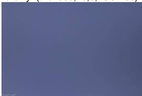
Fot. 8. Zdjęcie białej kartki wykonane w oparciu o światłomierz aparatu bez korekty. (t 1/4000; f5,6; ISO 400)
