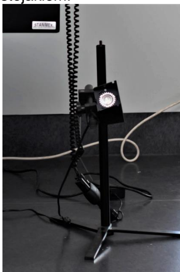
Fot. 38. Lampa z jedną diodą LED do podświetlania od spodu wraz z regulowany stojakiem.
