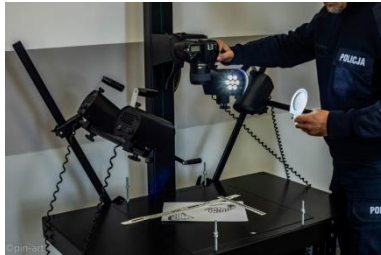
e) Lampa LED ze zdemontowanym dyfuzorem.
