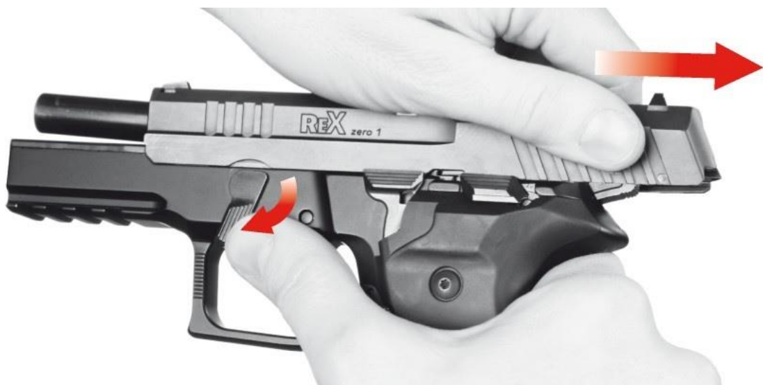
Ryc. 17. Zdejmowanie zamka. Źródło: Podręcznik rusznikarza Rex Zero 1.
