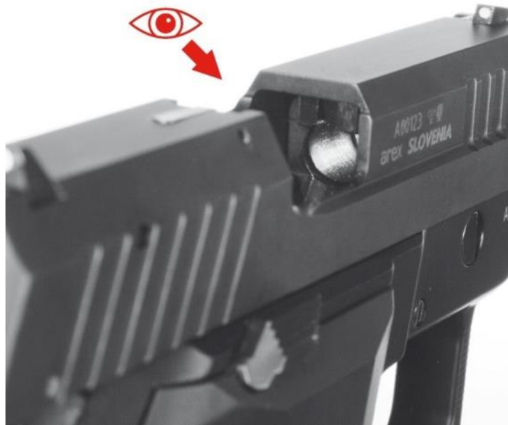
Ryc. 16. Sprawdzenie komory nabojowej. Źródło: Podręcznik rusznikarza Rex Zero 1.
