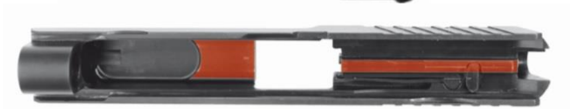
Ryc. 11. Zamek, miejsca smarowania. Źródło: Podręcznik rusznikarza Rex Zero 1
