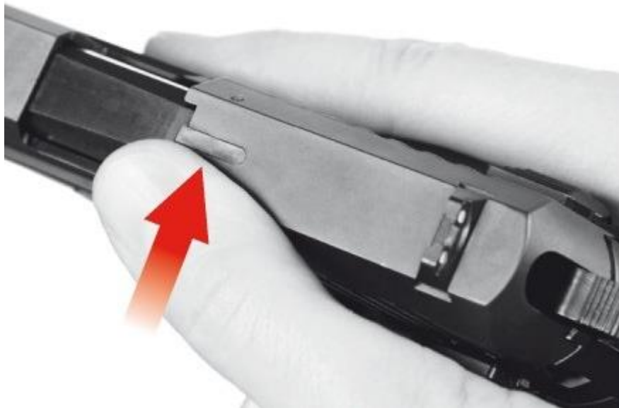
Ryc. 9. Wskaźnik obecności naboju w komorze naboju. Źródło: Podręcznik rusznikarza Rex Zero 1.
