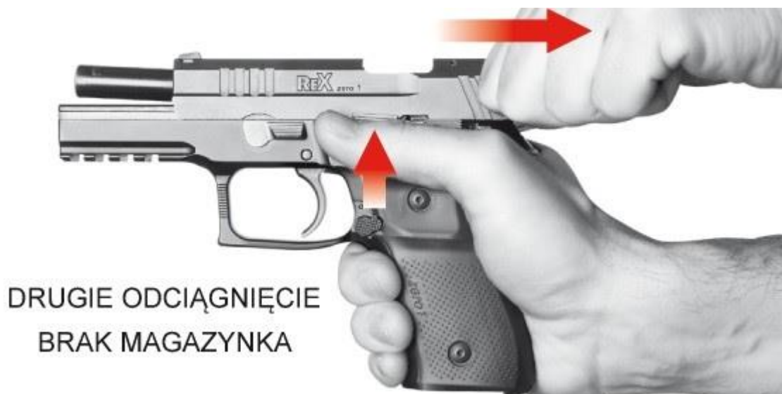
Ryc. 15. Zamek w tylnym położeniu. Źródło: Podręcznik rusznikarza Rex Zero 1.
