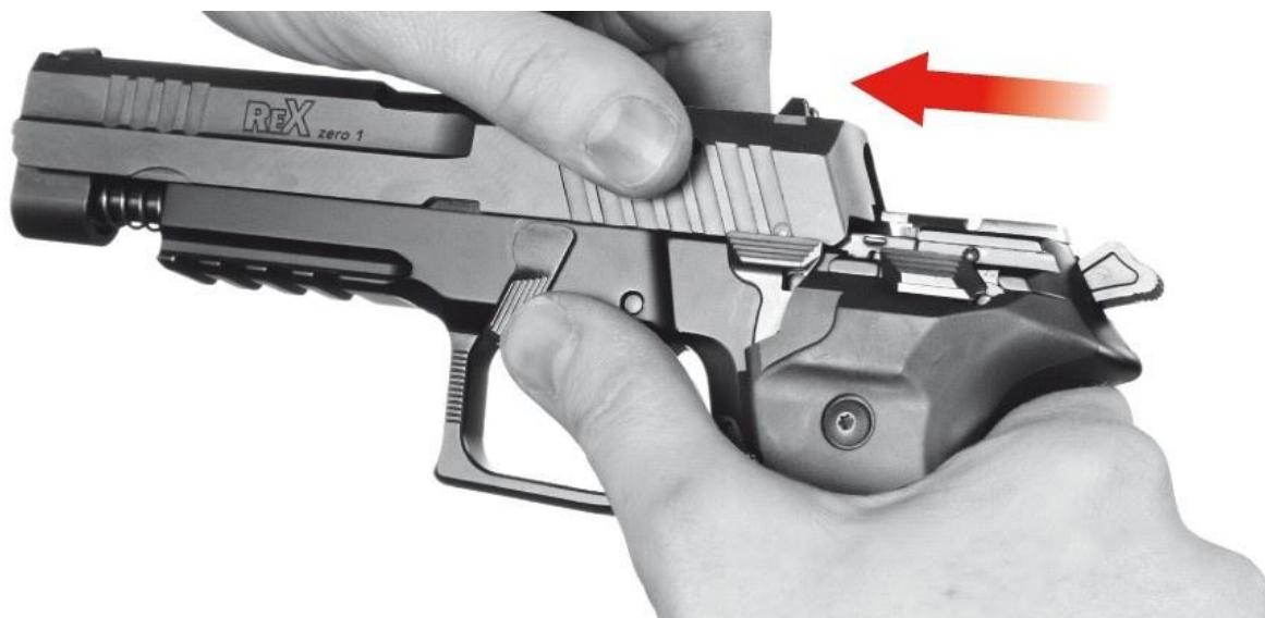
Ryc. 18. Zdejmowanie zamka c.d. Źródło: Podręcznik rusznikarza Rex Zero 1.
