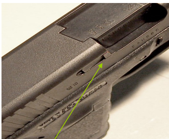
Brak wskaźnika obecności naboju w komorze nabojujowej (starsza wersja)
