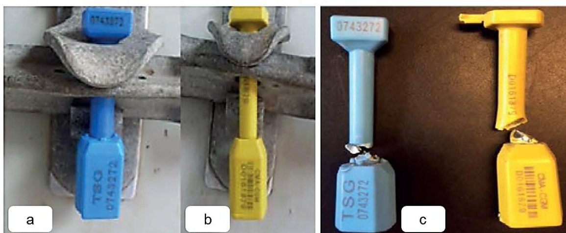
Ryc. 4. Oryginalne plomby bezpieczeństwa założone przez przewoźnika (a i b) i fałszywe plomby wydrukowane na drukarce 3D (wg. Vigilant, TAPA, September 2015 ).
