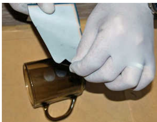
Nakładanie folii warstwą klejącą w kierunku ujawnionych śladów
