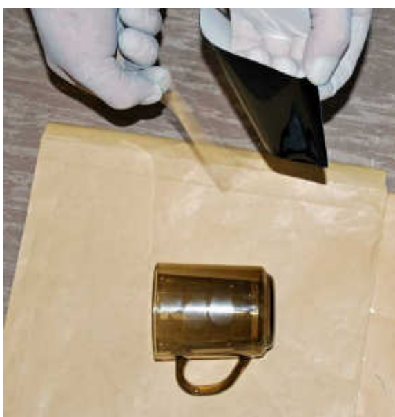
Zdejmowanie wierzchniej warstwy chroniącej klejącą powierzchnią folii
