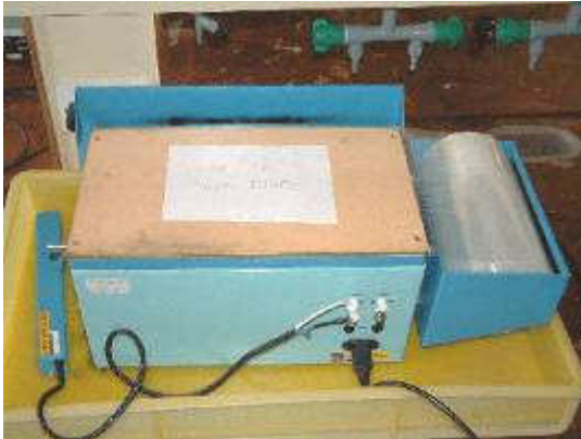
Widok aparatu ESDA oraz kartki z pismem wgłębionym
