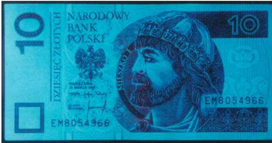
Widok w świetle ultrafioletowym podrobionego banknotu – brak widocznych odpowiednich zabezpieczeń
