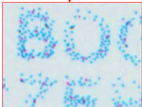
Wizerunki odbitek datownika imitowane za pomocą druku komputerowego
