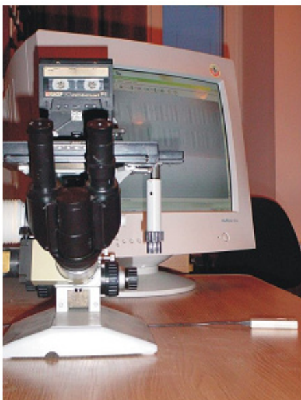
Zdj. 1. Mikroskop magnetoptyczny wizualizujący stan namagnesowania taśmy magnetofonowej wraz z podłączoną kamerą pozwalającą wprowadzić obraz do komputera i zapisać go oraz z wymiennym modulem mocowania taśmy (różnej wielkości kasety i różnej szerokości taśmy).
