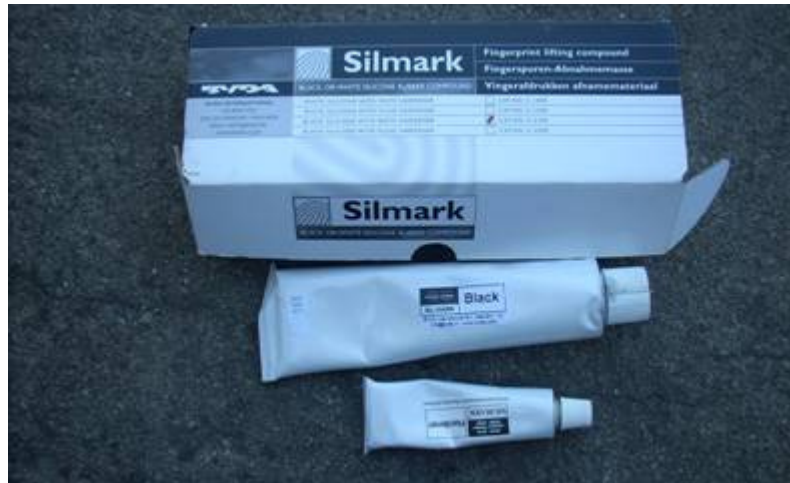
Zdj. 4. Silikon; duża tubka - masa podstawowa, mała - utwardzacz.
