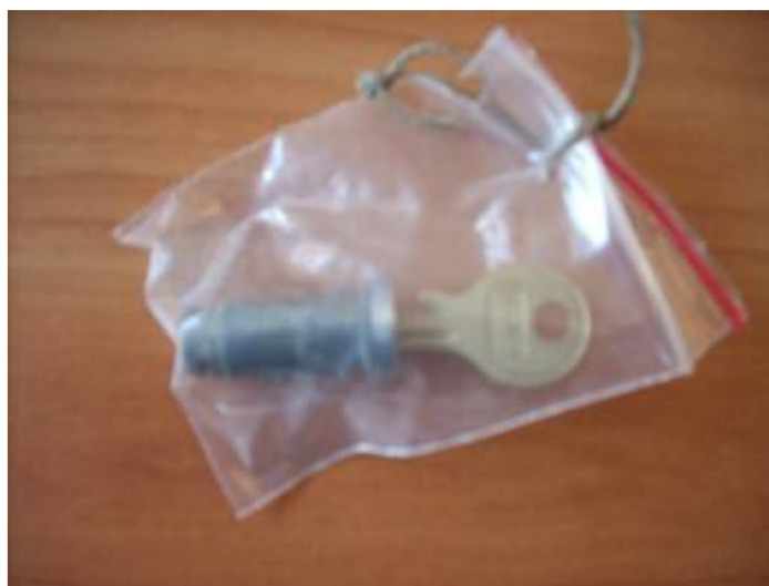
Zdj. 6. Przykład nieprawidłowego zabezpieczenia śladu mehanoskopijnego (jeżeli wkładka zamka oraz klucz znajdowały się osobno, nie można ich łączyć ze sobą, lecz zabezpieczać w odrębnych opakowaniach. Opakować należy w sposób uniemożliwiający przemieszczanie się śladów/przedmiotów wewnątrz opakowania, a tym samym powodowanie dodatkowych zmian na powierzchni.).
